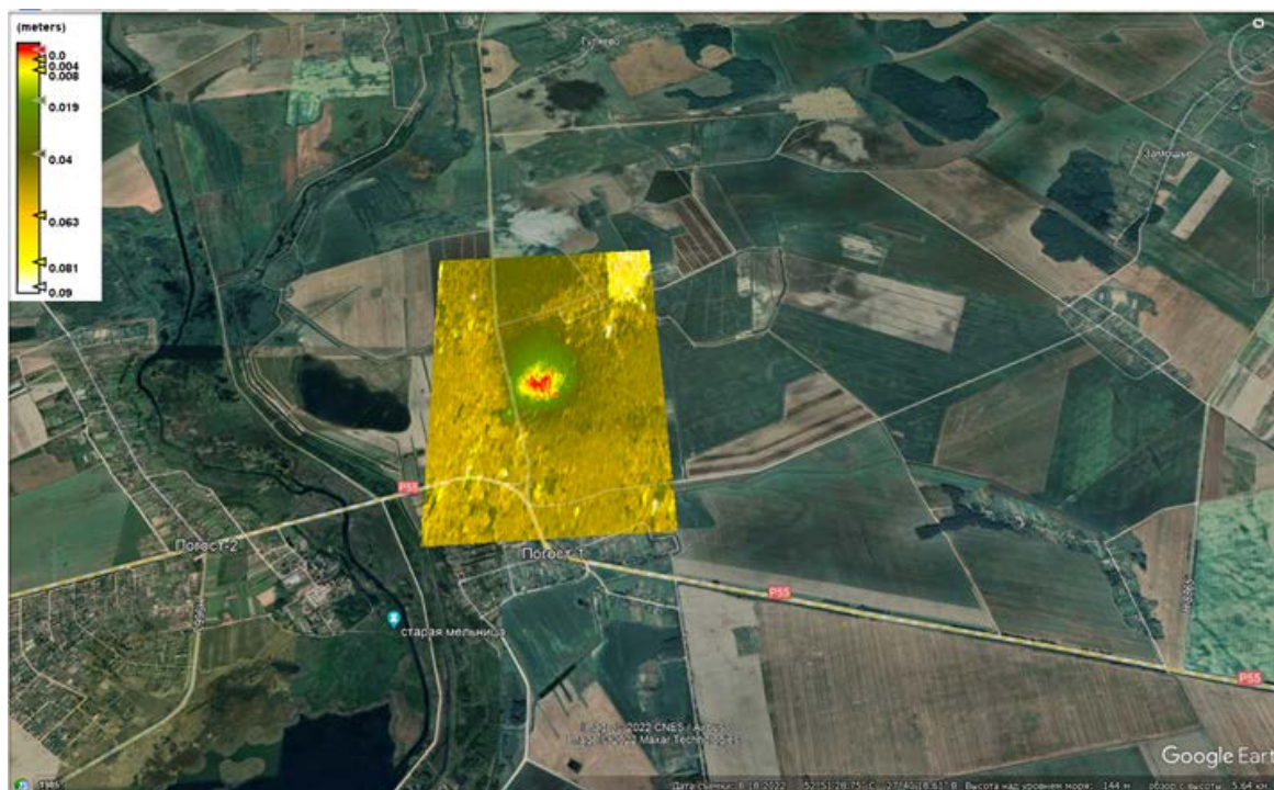
Рис. 4. Среднегодовые скорости смещения постоянных отражателей, мульда и профили оседаний, полученные на основе данных спутниковой платформы Sentinel-1
