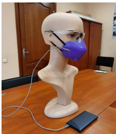
Рис. 2. Экспериментальные образцы защитной маски UV Guard Mask (а) и УФ рециркулятора (б)
