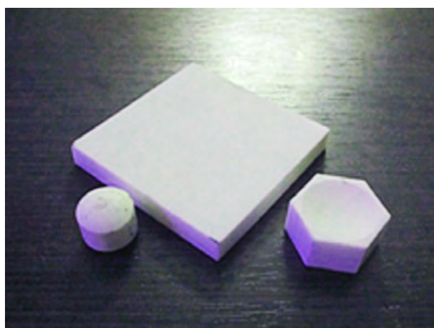
Элементы бронезащиты на основе оксида алюминия и карбида кремния
