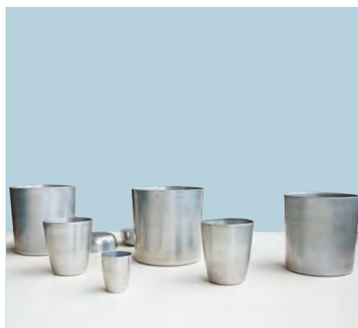
Детали, изготовленные гидроударной штамповкой
