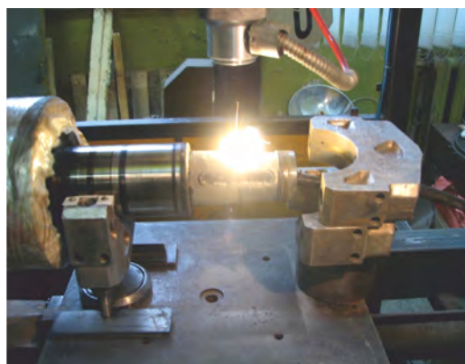
Процесс восстановления лазерной наплавкой конической поверхности ротора редуктора турбины
