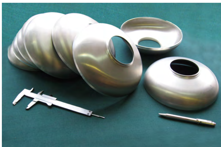
Детали, изготовленные гидроударной штамповкой
