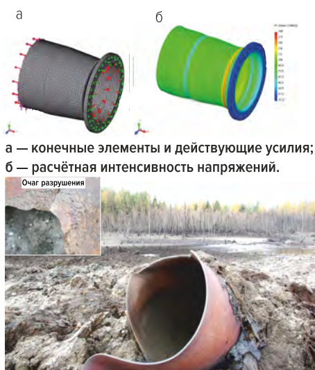
Последствия разрушения МГ (DN 700) вследствие интенсивной локальной коррозии с возгоранием. Очаг разрушения (сверху)
