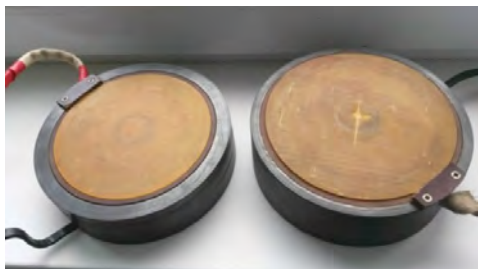
Индуктор для обработки плоских изделий (ножи, фрезы и др.)
