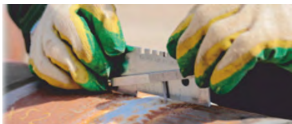
Визуально-оптический и измерительный контроль
