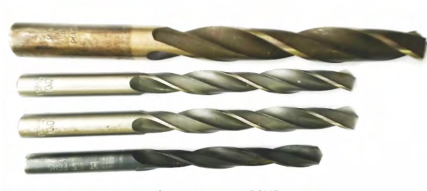
Сверла из стали Р6М5 Увеличение периода стойкости в 1,8 раза
