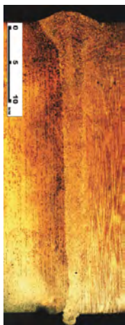
Соединение ЭЛС из сталей 40Х и 25ХГТ толщиной 35 мм
