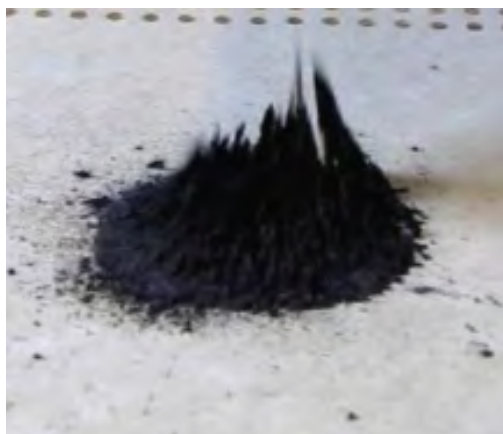
Микросферы никеля, полученные методом совмещения пиролиза аэрозоля и горения растворов
