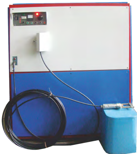
Электрогидроимпульсный пресс ЭГИП-30 энергоемкостью 30 кДж и максимально установленной мощностью 20 кВт
