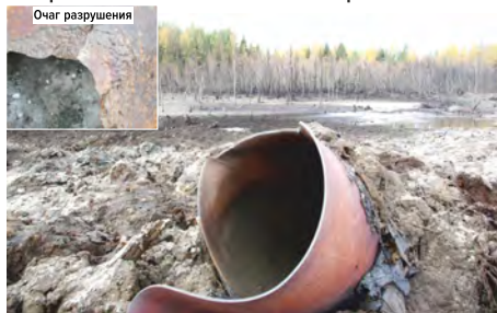
Последствия разрушения МГ (DN 700) вследствие интенсивной локальной коррозии с возгоранием. Очаг разрушения (сверху)
