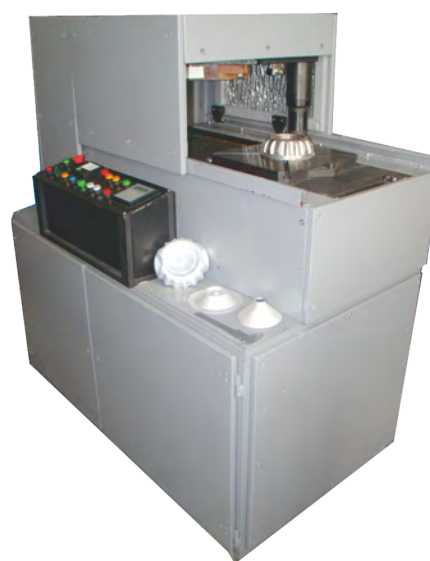
Магнитоимпульсный пресс МИП-20 энергоемкостью 20 кДж и максимальной установленной мощностью 15 кВт
