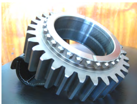
Шестерня после стендовых испытаний
