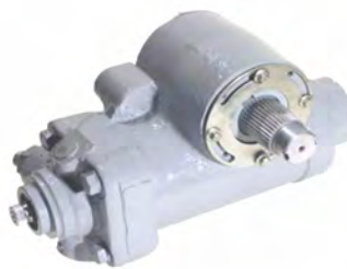
Элементы быстроизнашивающихся деталей рулевого механизма автомобилей после лазерного упрочнения
