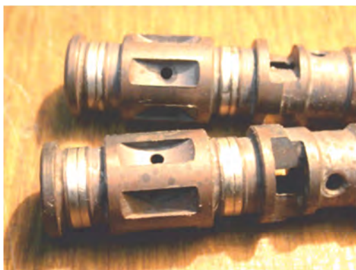
Вал-золотники с упрочненными рабочими шейками
