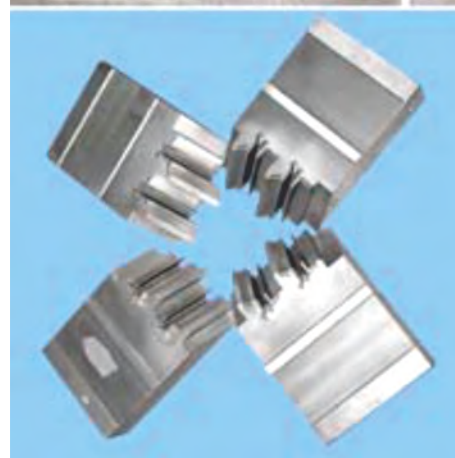
Восстановленный профиль фильер литья уплотнителя холодильника «Атлант»
