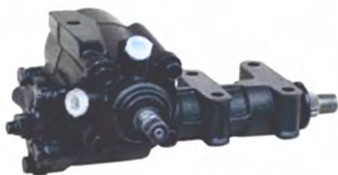
Элементы быстроизнашивающихся деталей рулевого механизма автомобилей после лазерного упрочнения
