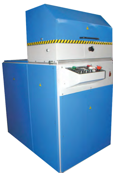
Магнитоимпульсный пресс МИП-10 энергоемкостью 10 кДж и максимальной установленной мощностью 10 кВт
