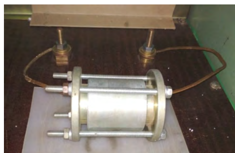
Цилиндрический индуктор для упрочнения деталей цилиндрической формы: сверл, штоков, винтов, сложнопрофильных деталей
