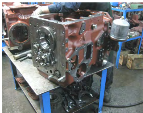
Установка шестерен в коробку передат
