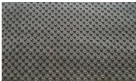
Фотография порошковой капиллярной структуры субмиллиметровой толщины (0,2 мм) для паровой камеры
