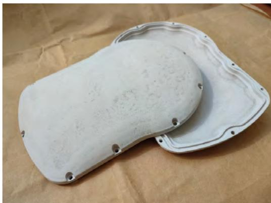
Защитные покрытия на деталях из магниевых сплавов
