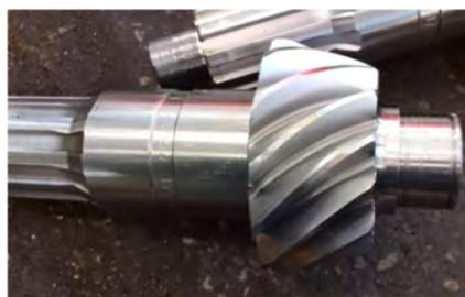
Зубчатые колеса из конструкционной стали 20ХНЗМА
