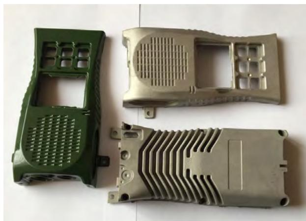
Детали корпуса радиопередающего устройства из магниевого сплава
