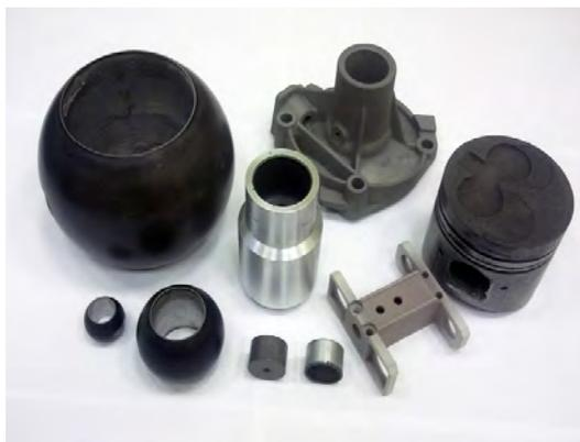
Износостойкие и защитные покрытия на деталях из алюминиевых сплавов
