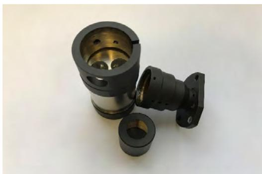
Защитные и функциональные покрытия на деталях из титановых сплавов
