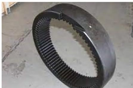
Шестерня из конструкционной стали 40ХМФА
