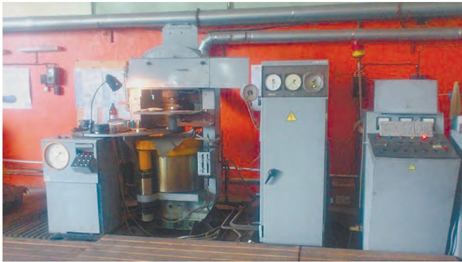
Прессовая установка для синтеза и спекания сверхтвердых материалов
