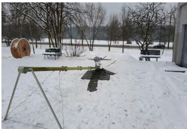
БЛА «Мишень» с турбореактивным двигателем на устройстве запуска
