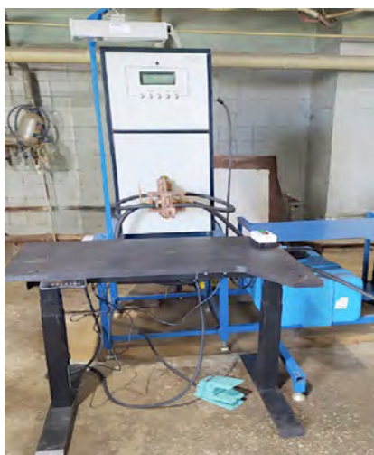
Пост пайки призматических инструментов
