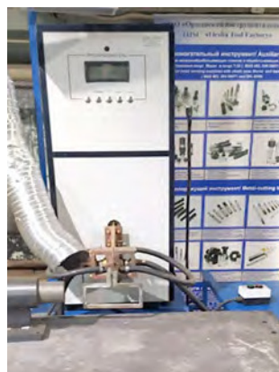
Пост пайки осевого инструмента
