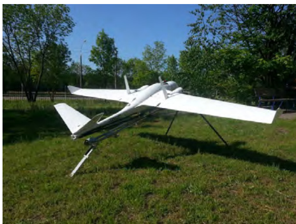
БЛА «Бусел М50» на устройстве запуска
