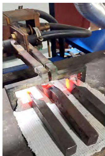
Пост пайки призматических инструментов
