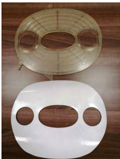
Мембрана ПС-100М в виде пластин для мембранного модуля МЗ7 (Alfa Laval)
