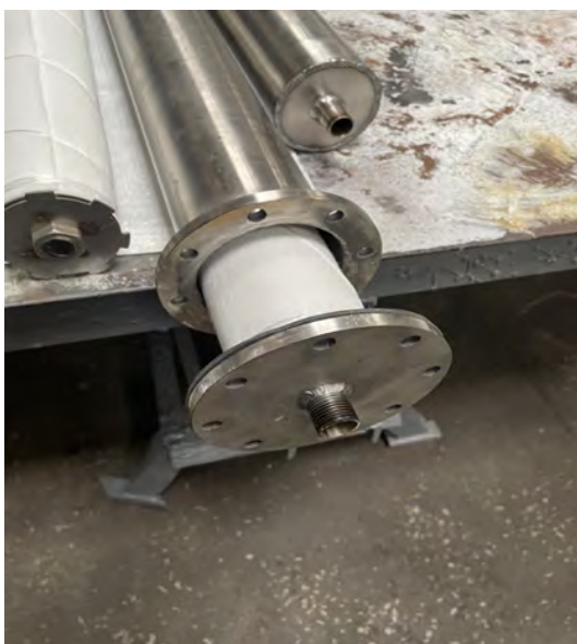
Фильтр, диаметр 89 мм, производительность 1 фильтра до 2 м 3 /ч
