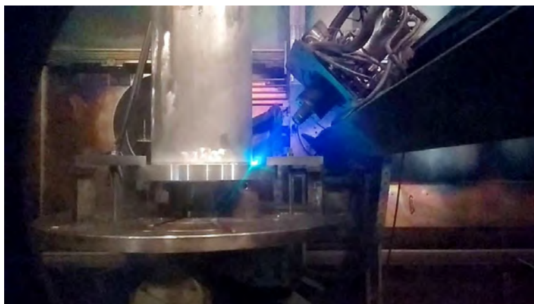
Процесс электронно-лучевой сварки в вакуумной камере электронно-лучевой сварки
