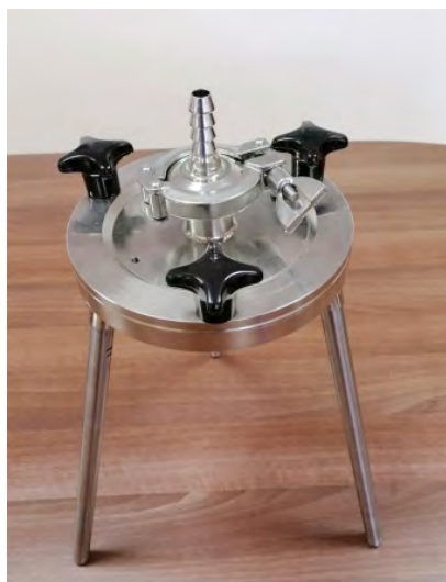
Установка стерилизующей фильтрации
