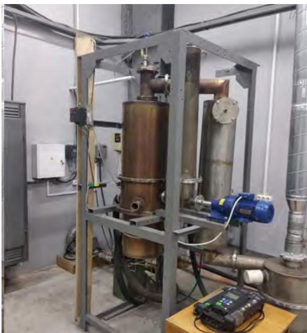
Экспериментальная установка с циклонно-слоевой топкой кипящего слоя для исследования особенностей сжигания твердого биотоплива (мощность 25 кВт)
