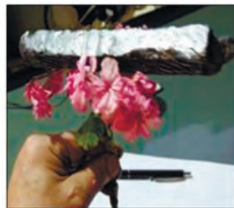
Материал с сотовой структурой пор на основе графена
