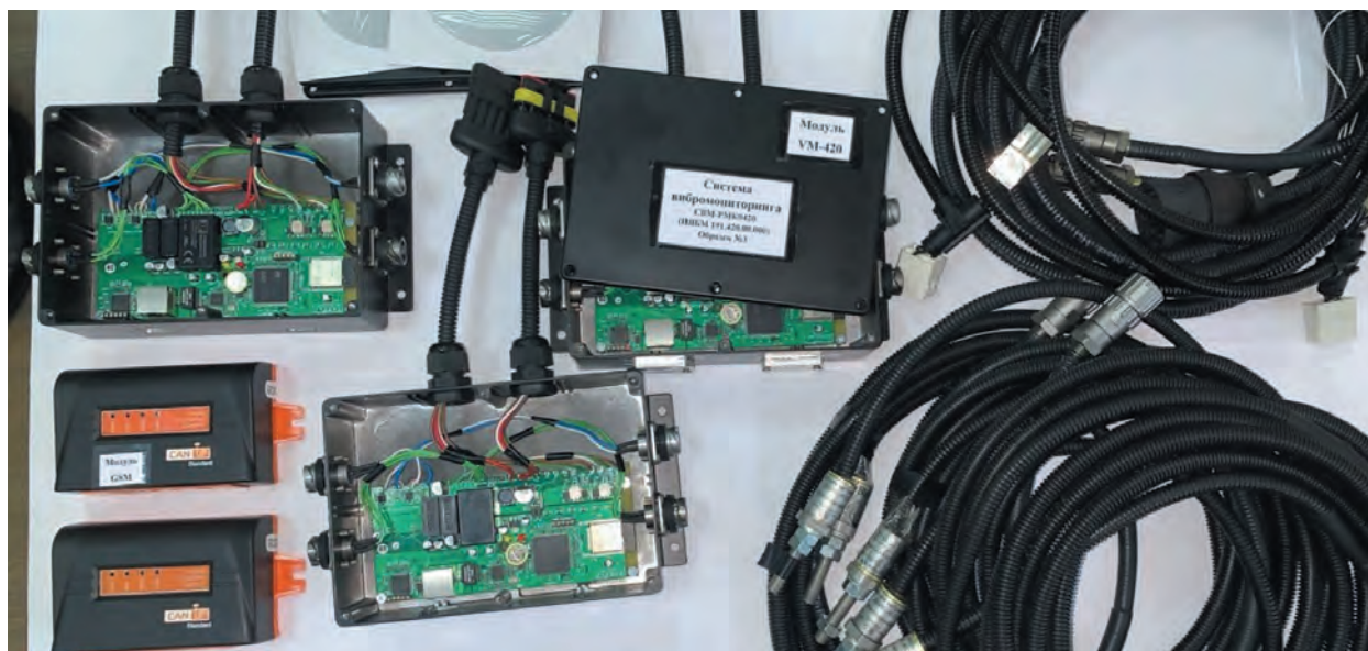
Комплекты модернизированной системы вибромониторинга РМК карьерных самосвалов с беспроводной передачей данных (СВМ-РМК-420)
