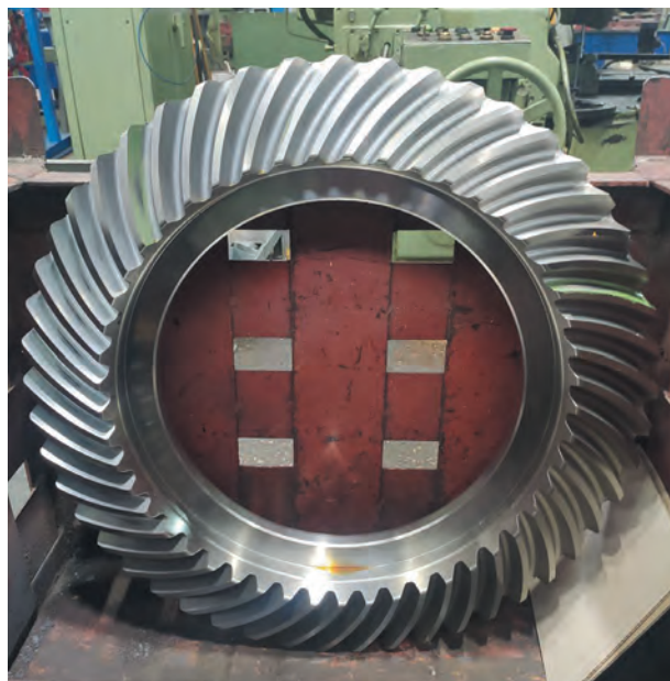
Экспериментальные конические зубчатые колеса карьерных самосвалов из стали 20ХН3А, микролегированной ванадием
