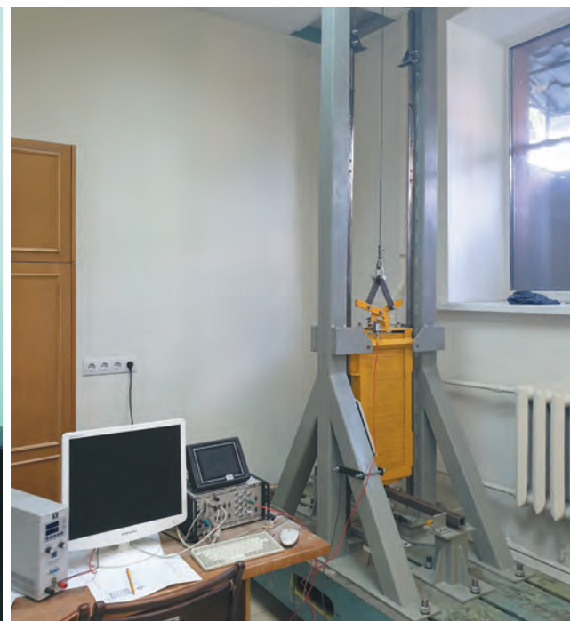
Испытательная установка для экспериментального определения параметров динамического упрочнения сталей
