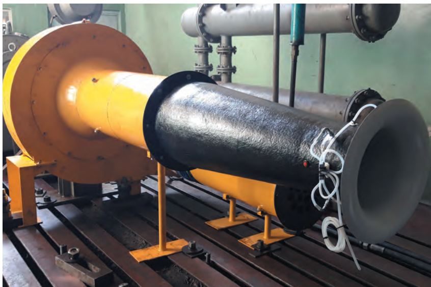
Доработанная стендовая установка, дооборудованная сужающим устройством (сопло Вентури)
