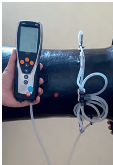
Стендовые измерения статического и динамического давления, развиваемого вентилятором системы охлаждения карьерного самосвала
