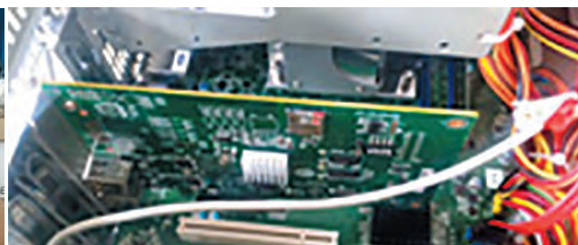
Модуль управления и контроля верхнего уровня, выполненный на платформе промышленного персонального компьютера
