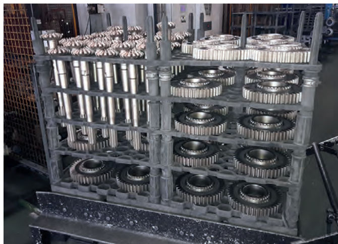
Детали трансмиссии трактора BELARUS, обработанные по технологии высокотемпературной цементации
