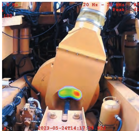
Экспериментальное определение уровня мощности звука вентилятора системы охлаждения базовой и доработанной конструкции
