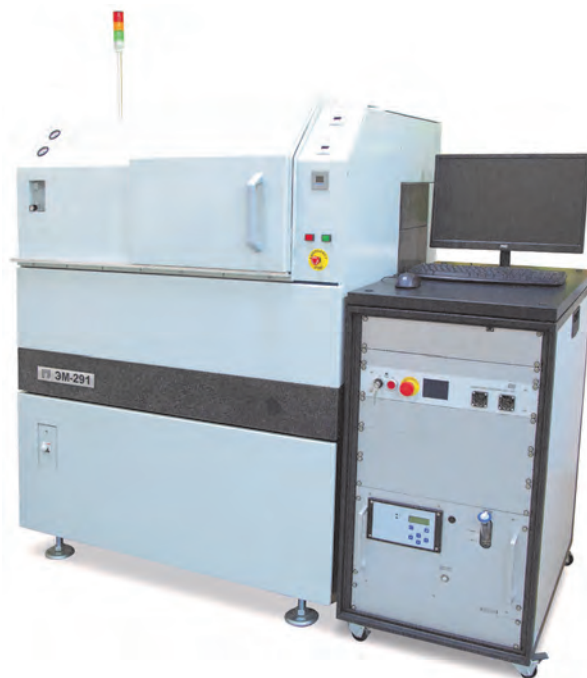
Установка для лазерной микрообработки материалов микроэлектроники
