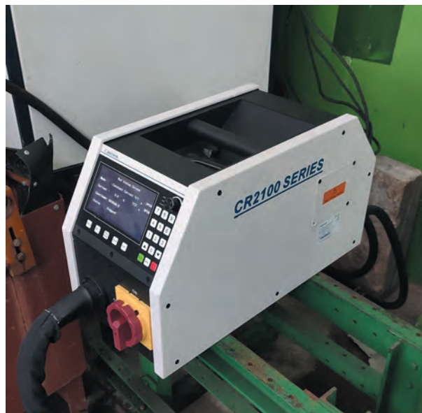
Образец установки СЭТО сварных соединений рамы карьерного самосвала
