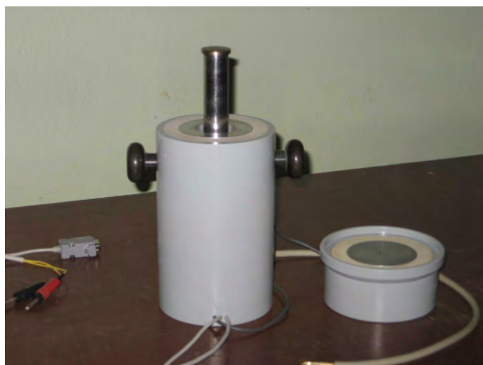
Рабочая камера калориметра для определения фазового состава воды в промораживаемых горных породах
