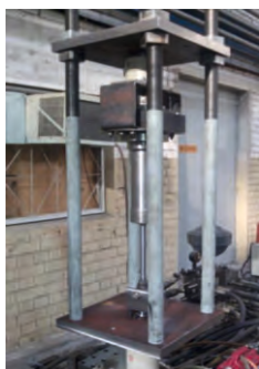
Амортизаторы с магнитным управлением (внешнее и внутреннее расположение) на силовых испытательных стендах ОАО МЗКТ
