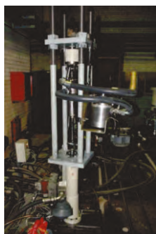
Амортизаторы с магнитным управлением (внешнее и внутреннее расположение) на силовых испытательных стендах ОАО МЗКТ
