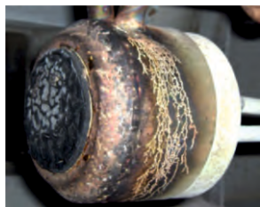
Образцы ТЗМ до и после испытаний
