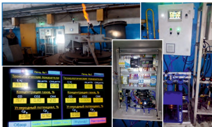
Система управления, работающая в комплексе с двумя цементационными печами
