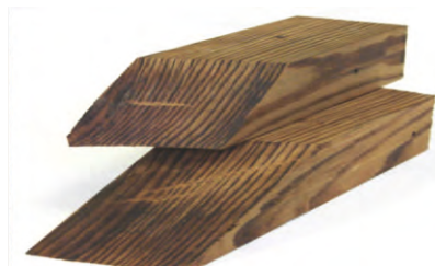
Внешний вид образцов после термомодификации (доска сосны толщиной 50 мм)
