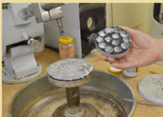
Технологический процесс полирования оптических деталей на станках 4ПД-200
