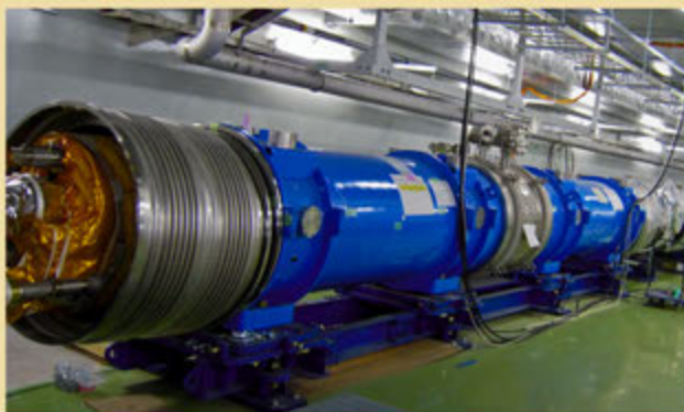
Сверхпроводящие магниты канала транспортировки протонов к нейтринной мишени
