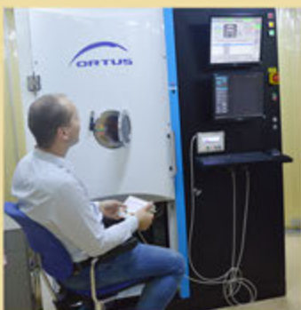
Процесс вакуумного напыления оптического покрытия на установках Ortus и Aspire
