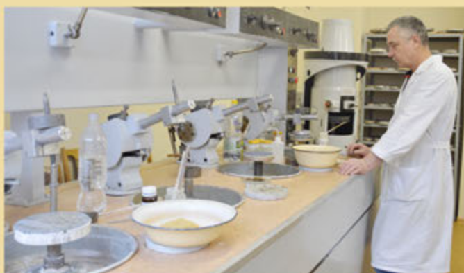
Технологический процесс полирования оптических деталей на станках 4ПД-200
