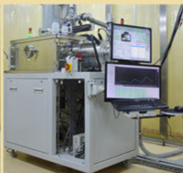
Процесс вакуумного напыления оптического покрытия на установках Ortus и Aspire
