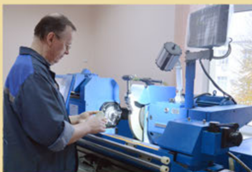
Процесс обработки заготовки оптической детали на круглошлифовальном станке RSM500A
